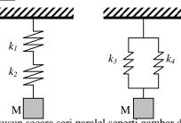
Pegas disusun secara seri paralel seperti gambar di atas. Ujung pegas digantungi beban yang sama besar. Bila kontanta pegas  $k_1 = k_2 = k_3 = k_4 = k$ , maka perbandingan periode susunan seri dan paralel adalah ...
