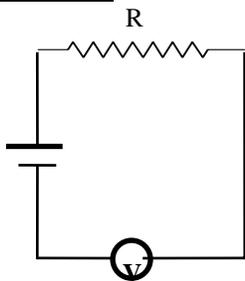
Untuk mengukur hambatan (R) di pakai suatu rangkaian sebagaimana diperlihatkan pada gambar. Batere E dengan GGL 12 V yang hambatan dalamnya diabaikan, dihubungkan seri dengan hambatan yang dicari (R) dan voltmeter (V) yang hambatannya ( $R_V$ ) 20 k $\Omega$ .
